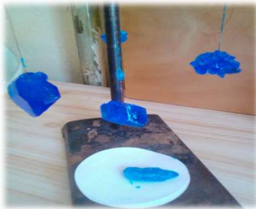
Рисунок 1 - Кристаллы медного купороса, полученные из \text{CuSO}_4
