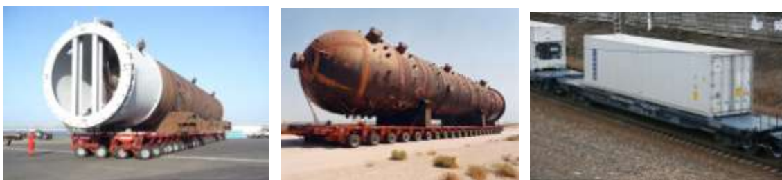
Рисунок 2 – Перевозка оборудования автомобильным и железнодорожным транспортом
